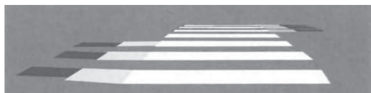
3D-искусственная неровность (обозначает приподнятый пешеходный переход на дорогах).
